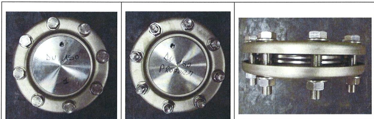
L'étanchéité entre les brides de l'assemblage est assurée par un joint EPDM.
