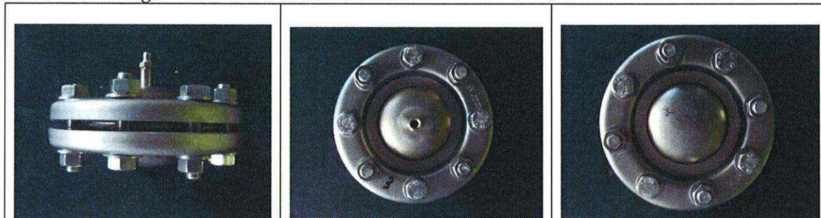
L'étanchéité entre les brides de l'assemblage est assurée par un joint ASK 400.
