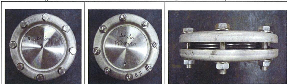
L'étanchéité entre les brides de l'assemblage est assurée par un joint EPDM.
