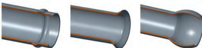
Par expansion ou rétreint radial : jusqu'à tube  $\varnothing$ 80 mm
